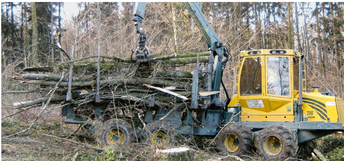
Kombi-Forwarder im Rheinfelder Wald in Aktion – 70% des Holzes ist heute Kurzholz, das im Waldbestand auf das Kranfahrzeug verladen und huckepack an die Waldstrasse gefahren wird.
